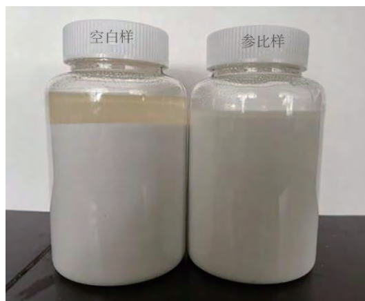
图 10 纳米纤维素水性丙烯酸涂料热贮存稳定性 [58]
